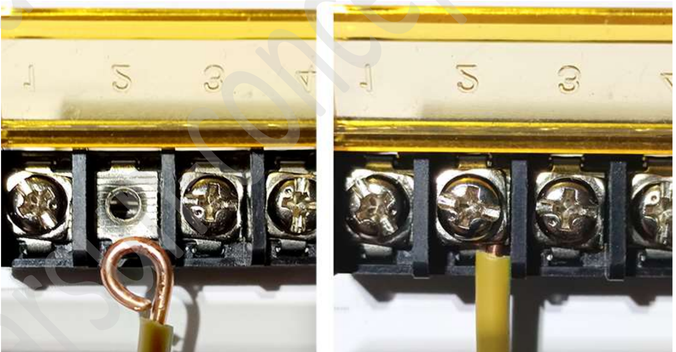
Schéma 8 : Si le bornier de votre routeur est noir Serrage à 0,6 N.m
